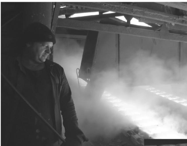
По основному оборудованию проводится ревизия с заменой изношенных деталей, в частности на редукторах приводов лент, кантовальной лебёдке, опрыскивателях мульд.
