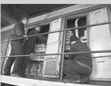
На сегодняшний день отремонтированы агрегаты тепловозов ТГМ-6 №№1907. По анализу отработанного времени и расходу ГСМ после проведенного ремонта дизель и гидропередача тепловоза по параметрам вошли в утвержденные нормы – работают стабильно, без перерасхода ГСМ.
