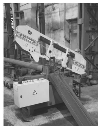
На заводе постоянно обновляется оборудование и механизмы. Для заготовительного участка РМЦ приобретена новая ленточнопильная пила для нарезки заготовок, из которых производятся детали для металлургического производства. Львиная доля этих деталей идет для нужд доменного цеха.
